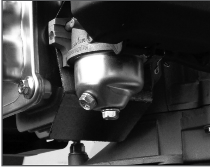
Рис. 13 Слив топлива из карбюратора 1. Болт сливной
