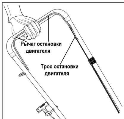
Рис. 7 Проверка работы троса остановки двигателя
